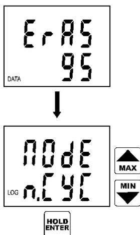
Tím je spuštěna procedura mazání, její průběh je indikován na displeji průběžným zobrazením procentuální hodnoty velikosti už vymazané paměti (číslicemi 0 až 100).
